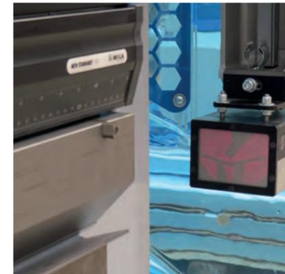
RapidBend Ultimate minimise les Mouvements de vitesse "lente" de la machine. Le poinçon atteint la vitesse maximale jusqu'au contact tôle pour tirer le meilleur parti des performances de la machine. RapidBend est la technologie innovante qui réduit le cycle normal de la machine jusqu'à 2 secondes, ce qui réduit considérablement le temps de fonctionnement et réduit les coûts.
