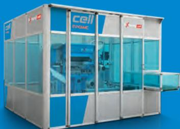
Cellule de pliage robotisée
