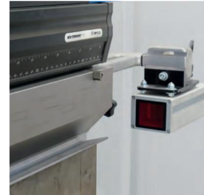
Permet à l'opérateur de travailler en toute sécurité à proximité des outils, même lorsque le coulisseau et la butée arrière se déplacent à grande vitesse. La vitesse maximale va jusqu'à 6 mm du point contact avec la tôle. Le système surveille en permanence la performance de la vitesse du coulisseau
