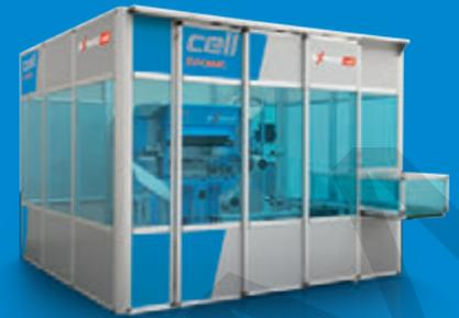
Cellule robotisée de pliage
