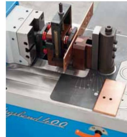
Outil de poinçonnage pour trous jusqu'à Ø 30 mm.
