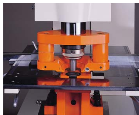
*Ressort dévettissage en urethane pour déformation minimum
