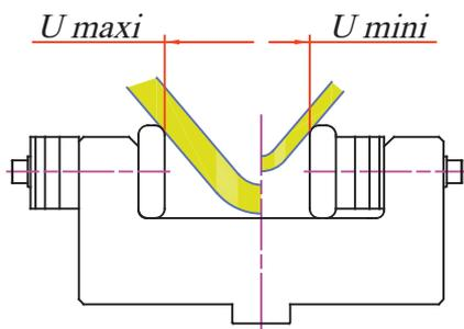
*Réglage par déplacement de cales à l'arrière des inserts*
