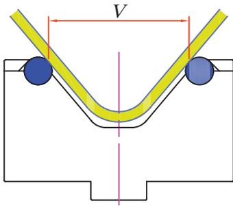
*Cette matrice permet un meilleur glissement de la tôle pendant le pliage. Elle peut être réalisée en différentes versions, en fonction des épaisseurs et du type de matériau à plier.*
