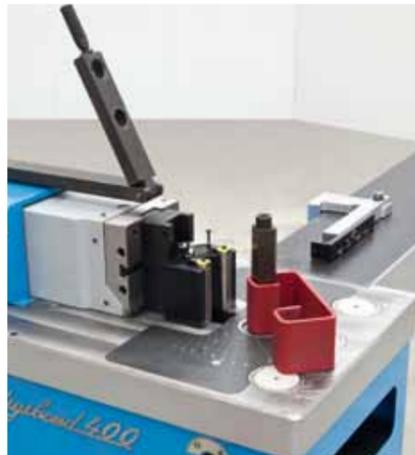
Tourillon de pliage Ø 50 mm, H=200 mm, matrice et barre anti-flexion.
