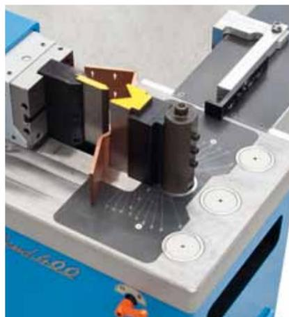
Poinçon de pliage mobile et matrice fixe pour plis rapprochés.
