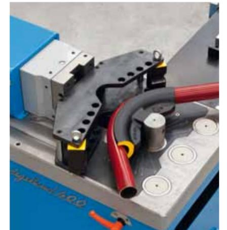
Outil à 2 mâchoires pour tubes gaz 3/8" (17,2 mm) jusqu'à 2" (60,3 mm) et barres rondes jusqu'à 90°.
