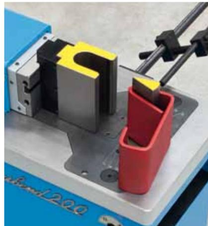
Tourillon de pliage à 30° avec matrice en forme de U pour plier des plats jusqu'à 30°.
