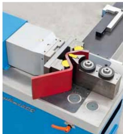
Outils de pliage H=400 mm pour pliage de tôles
