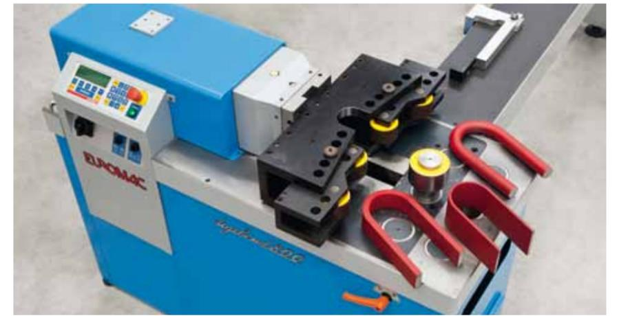
Outil à 4 mâchoires pour barres et tubes fortes épaisseurs, ronds, carrés, rectangulaires jusqu'à 180°.
