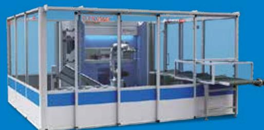
Cellules de pliage robotisées
